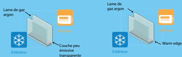
Double vitrage 4/16/4 avec lame argon de 16 mm, couche de faible émissivité
