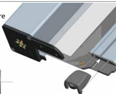
Encastrer le carter avec sa roulette sur l'embout bas de lame finale (trous de centrage)
